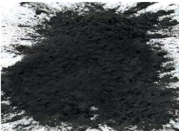
ภาพคาร์บอนแบล็กผงละเอียดหลังบดแล้ว
