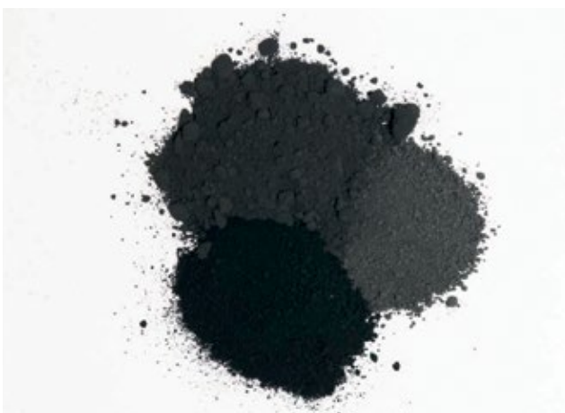
ภาพผงสีคาร์บอนแบล็ก 3 ระดับความเข้มข้นอยู่กับขนาดอนุภาค หรือพื้นที่ผิวของแต่ละอนุภาค
